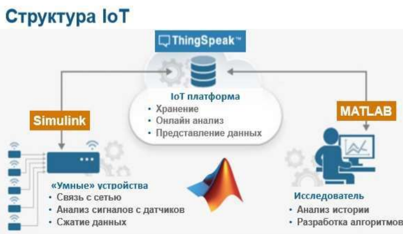
Рисунок 3.22 Matlab и обработка данных, полученных с IoT устройств
