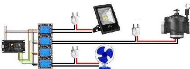
Рисунок 3.19 Схема подключения Приемника ESP32 и ИМ
