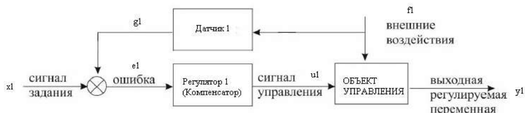
Рисунок 3.9 Структурная схема САР по возмущению (Компенсатор возмущений)
